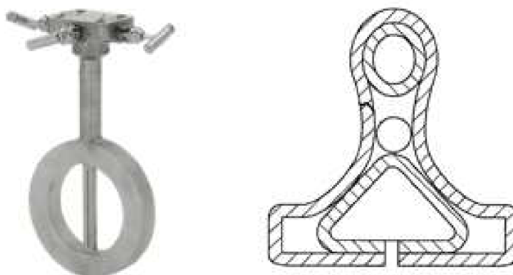
Obrázek 5: Vlevo - rychlostní sonda [20], vpravo - průřez sondou Annubar [21].
