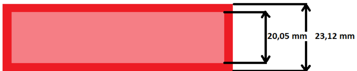
Obr. 18 Tvar a tloušťka stěny použité plastové nádoby
