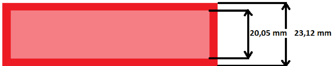
Obr. 18 Tvar a tloušťka stěny použité plastové nádoby
