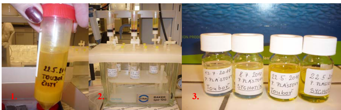
Obrázek 55: Ukázka přípravy vzorků: Panel 1: Zkumavka s roztokem vzorku; Panel 2: SPE zařízení, Panel 3: Vzorky pylu nachystané na zkoncentrování
