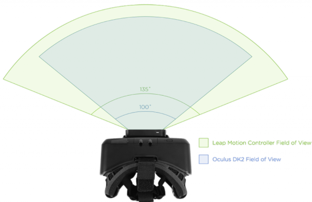
Obrázek 19: Zorná pole Leap motinu a Oculus riftu 19
