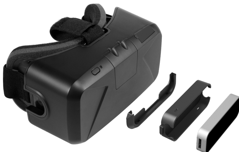
Obrázek 18: Přichycení Leap motion k Oculus riftu 18
