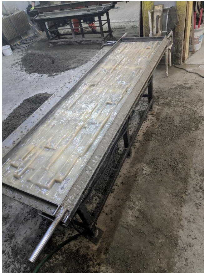
Obrázek 10 Forma desky pracoviště A, forma sloupku pracoviště B
