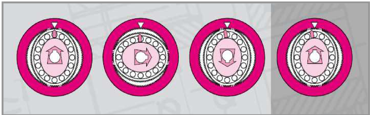
Obr. 18 Princip funkce převodovky Harmonic drive [6]
