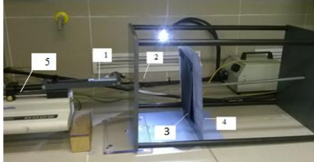
Obr17. Schéma zariadenia pre elektrostatické zvlákňovanie roztoku z ihly, (1) striekačka s polymérnym roztokom, (2) ihla, (3) nanovlákná putujúce ku kolektoru, (4) zberný kolektor, (5) dávkovacia pumpa
