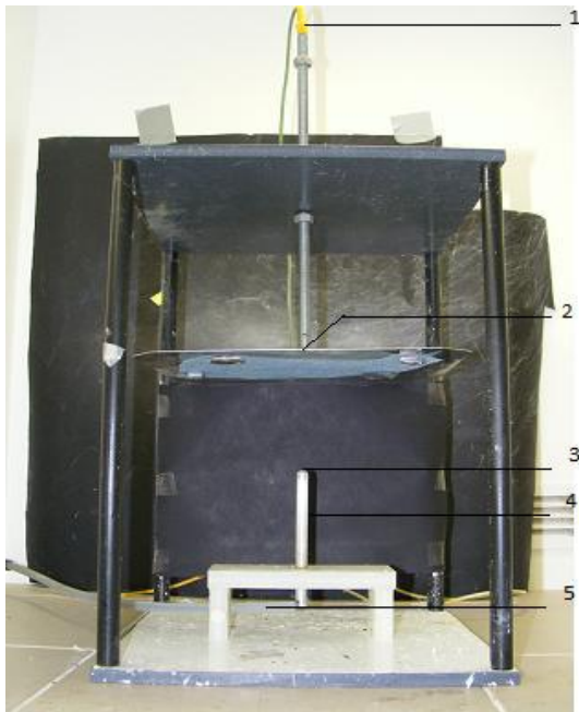
Obr. 18 Schéma zariadenia pre elektrostatické zvlákňovanie z roztoku z tyčky A) laboratórne zariadenie TUL, B) schéma elektrostatického zvlákňovania z tyčky Prevzaté (29). Zdroj vysokého napätia (5), zvlákňovacia elektróda (4), polymérny roztok v kvapkovom množstve (3), uzemnený kolektor (1), jednotlivé nanovlákná (2)
