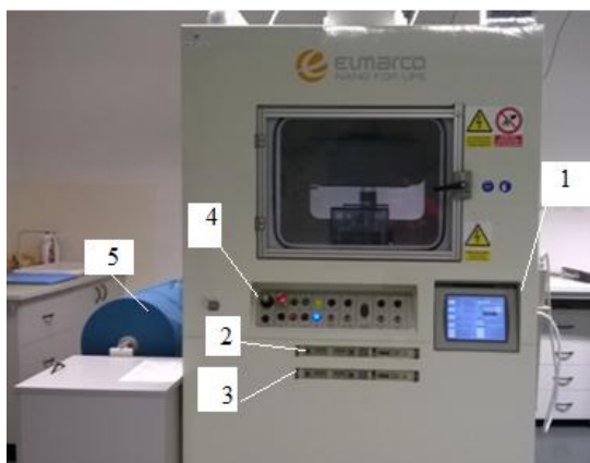
Obr. 22 Schéma zariadenia pre elektrostatické zvlákňovanie Superlab
