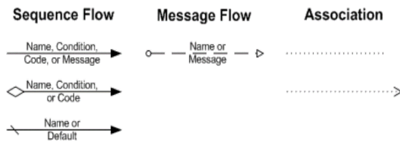
Obrázek 6: Rozdělení spojovacích objektů dle BPMN; Zdroj: (8)
