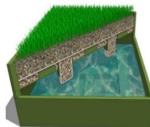
Modro-zelená střecha: nová upravená verze zelené střechy využívající substrát, vegetaci a dodatečnou akumulční nádrž k zadržení většího množství srážkové vody množství dalších výhod
