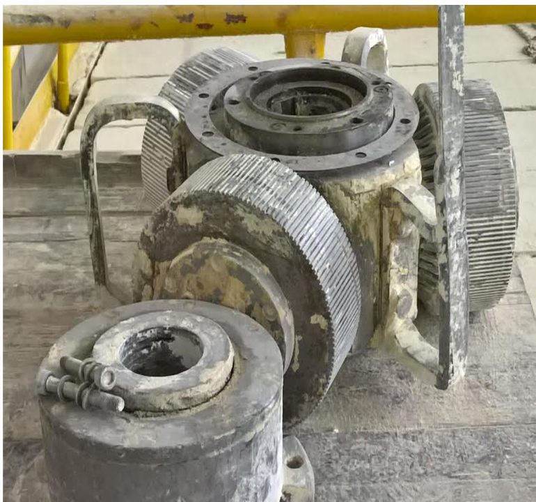
Obr.22 Prítlačné valce na maticu lisu. Nákres (vľavo) [13], záber skutočnosti (vpravo).
