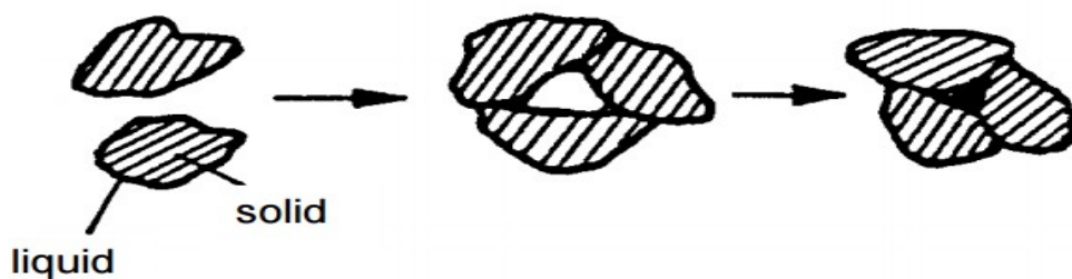
Obr.17 Nukleácia častíc pri peletizácii [12].
