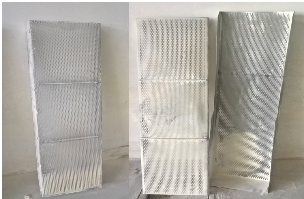
Obr.7 Sítá na triediči (príklad). Vľavo – sito na triedenie minigranulátu, vpravo na peletky.
