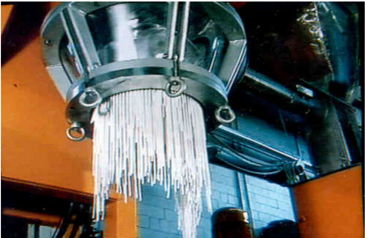
Obr.25 Prepadávajúci materiál z peletizátora [13].
