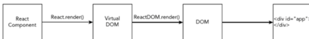
Obrázek 5: Vztah mezi Reactem, ReactDOM a webovým prohlížečem. Zdroj: [18]
