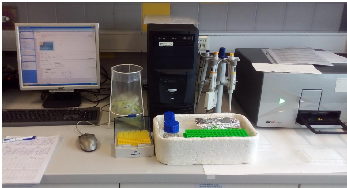
Obr. č. 8: Spektrofotometrický přístroj Infinite M200 (Tecan) a další laboratorní vybavení použité při měření enzymatické aktivity katalázy (CAT) a ostatních biomarkerů.
