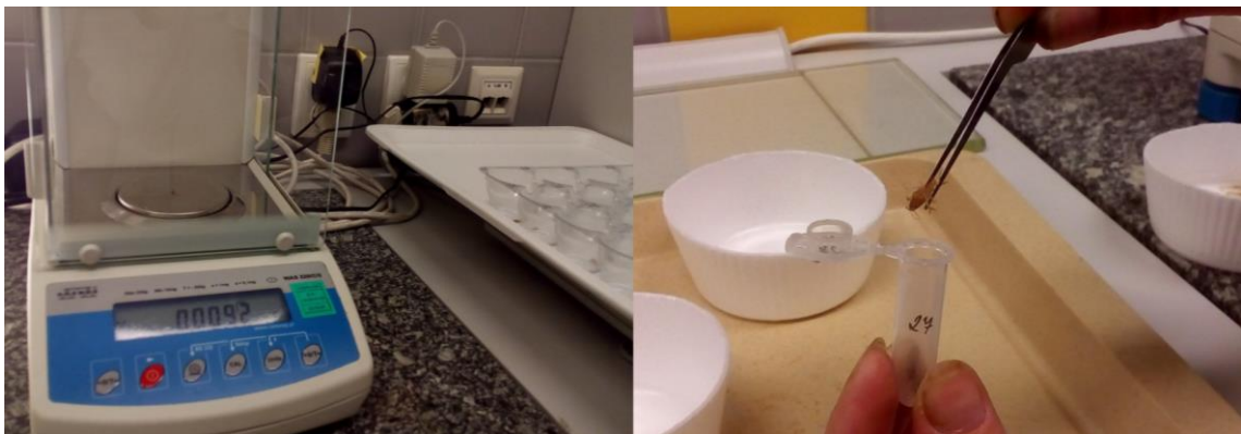
Obr. č. 7: Vážení testovaných jedinců na analytické váze a následné umístění do mikrozkušavky Eppendorf pro zmrazení v tekutém dusíku.
