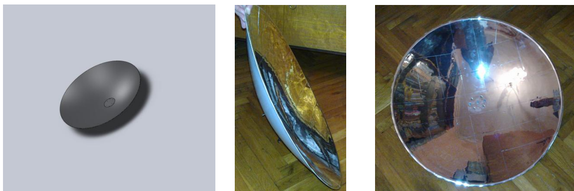
Obr. 20: Parabolická anténa – model solidworks a fotografie reálné paraboly [13]
