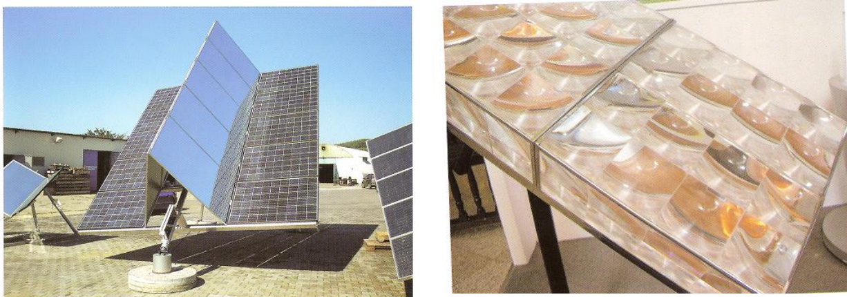
Obr. 11: Koncentrátory: vlevo se nachází koncentrátor typu Traxle s automatickým pohyblivým stojanem, vpravo se nachází koncentrátor záření na bázi Fresnelových čoček. [4]
