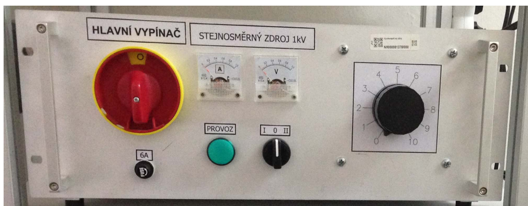
Obr. 11 – Stejnosměrný zdroj 1kV s možností regulace pro napájení magnetronu
