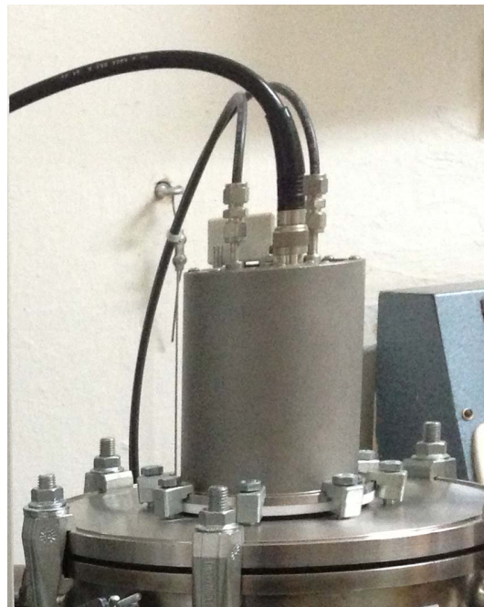
Obr. 10 – Magnetron uchycený k reaktoru
