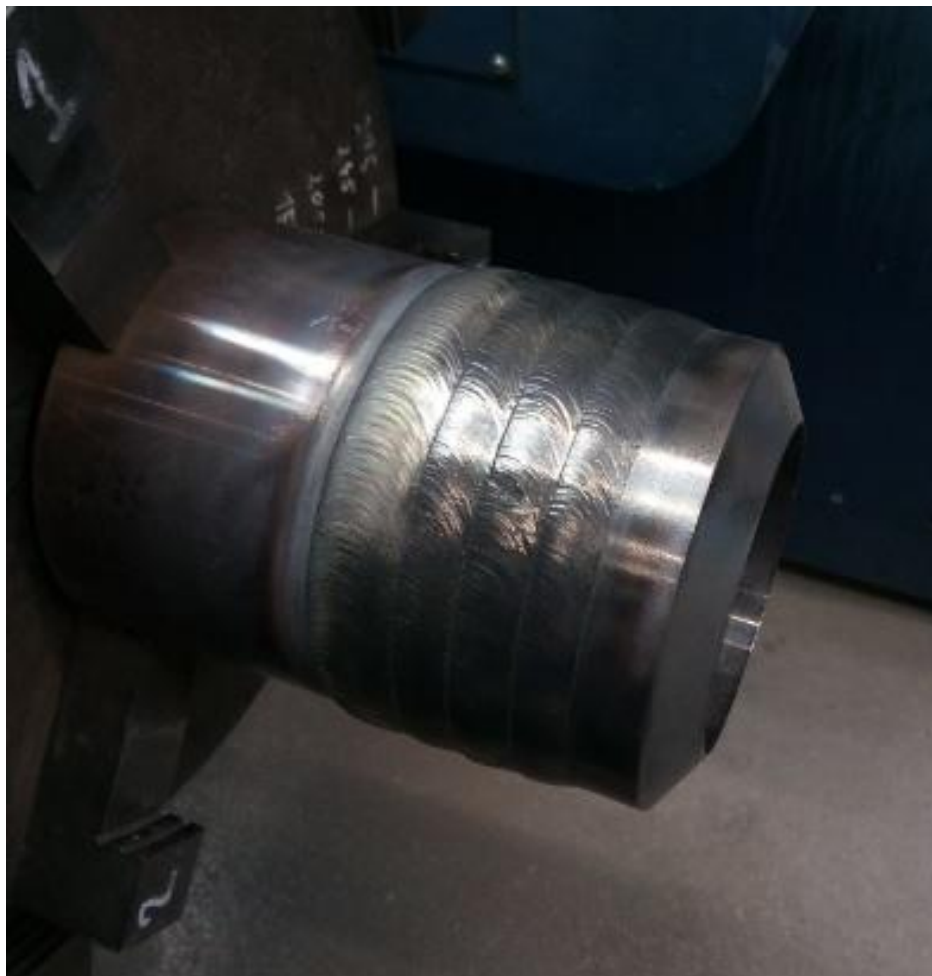
Obr. 38 Návar čtvrté housenky – první vrstva
