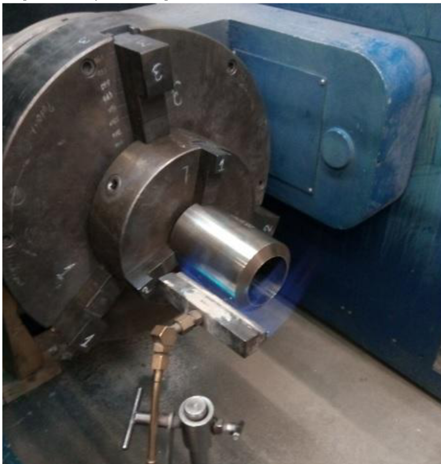
Obr. 34 Předehřev součásti pomocí plamene
