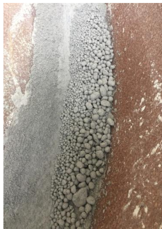
Obrázok č.24: Vzniknuté granule (solidifikát) na granulačnom tanieri
