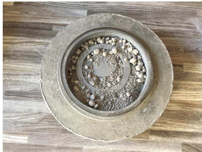
Obrázok č.30: Plnenie mlecej nádoby vibračného mlyna granulami solidifikátu
