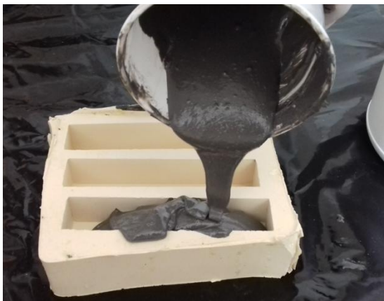
Obrázok č.32: Plnenie formy namiešanou hmotou
