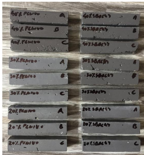
Obrázok č.37: Vzorky škárovacích hmôt v polymerizovanom stave
