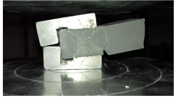
Obrázok č.44: Porušenie vzorky po zatažovaní tlakom
