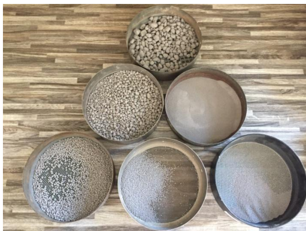
Obrázok č.26: Zostatky granúl na jednotlivých sítách po stanovení zrnitosti sitovým rozborom
