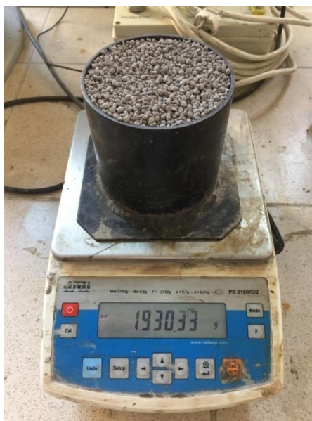
Obrázok č.28: Váženie nádoby naplnenej frakciou granúl 4—8 mm pre stanovenie sypnej hmotnosti
