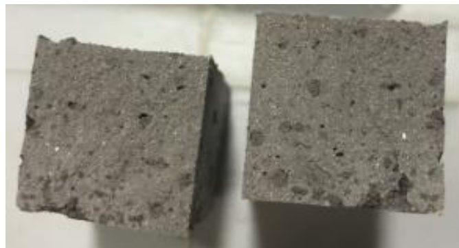
Obrázok č.41: Lomová plocha hmoty s pridaním 40 % plniva z granulácie
