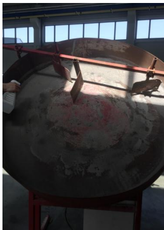
Obrázok č.23: Granulovanie zmesi na granulačnom tanieri
