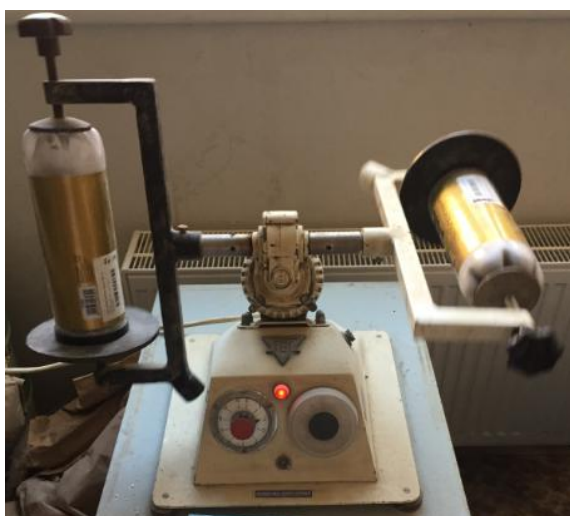
Obrázok č.31: Suchá homogenizácia dvoch rôznych zmesí NO s fluidným filtrovým popolčekom
