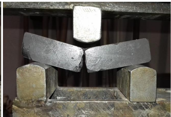
Obrázok č.40: Porušenie vzorky po zaťažovaní trojbodovým ohybom
