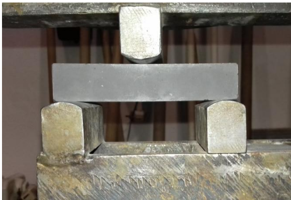
Obrázok č.39: Zaťažovanie vzorky trojbodovým ohybom
