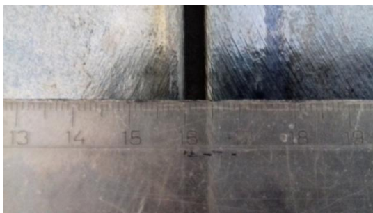
Obrázok č.34: Hrúbka škáry dlaždíc z taveného čadiča — 4 mm
