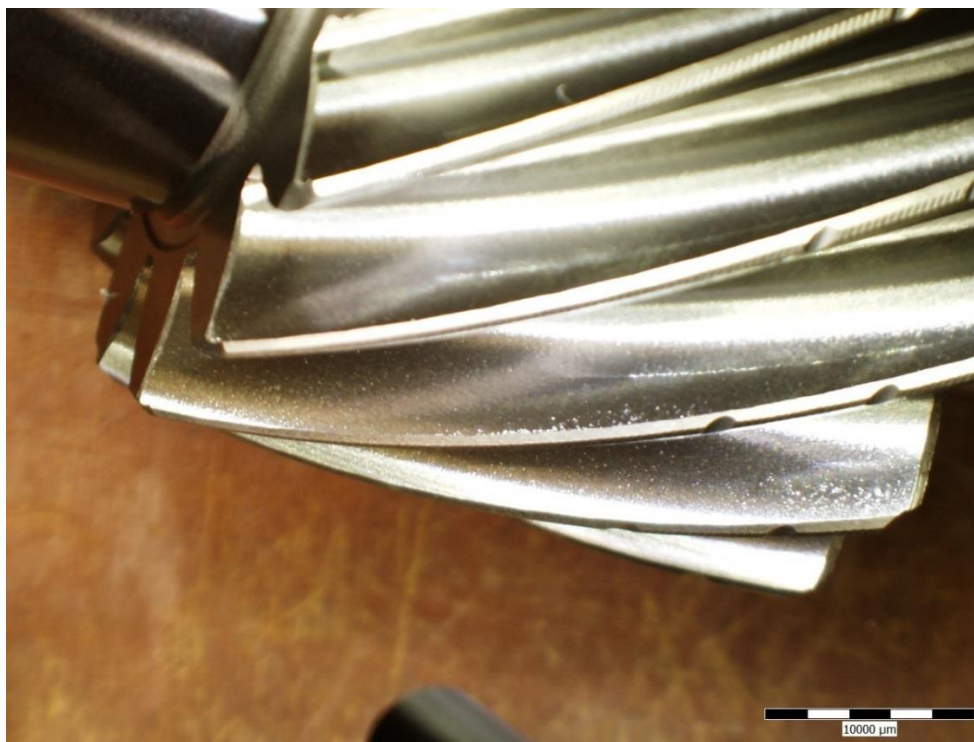
Obr. 0-13 Povrch honovaného boku zubu pod mikroskopem (zvětšení 1:0,0001)
