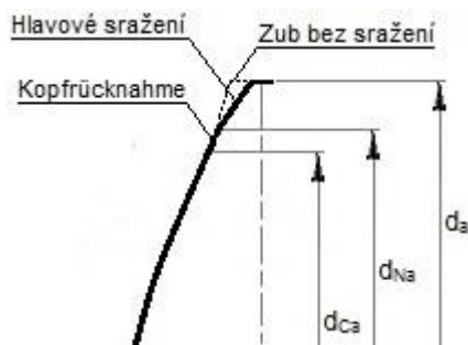
Obr. 2-5 Zub s hlavovým sražením a Kopfrücknahme
