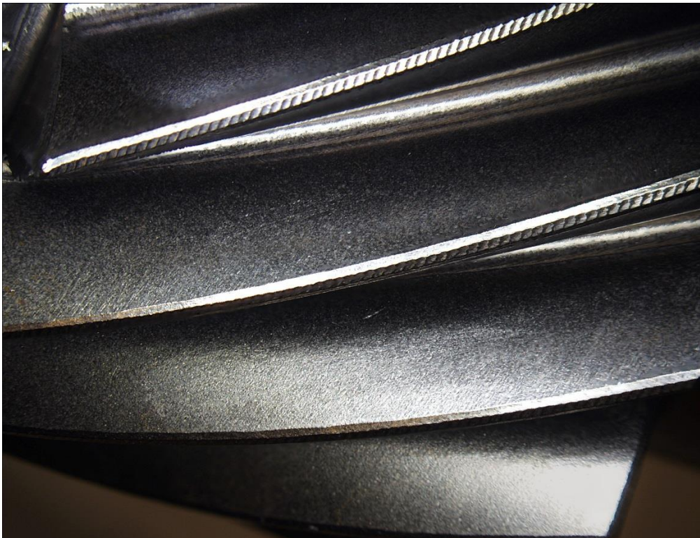
Obr. 0-17 Povrch ševingovaého boku zubu pod mikroskopem (zvětšení 1:0,0001)
