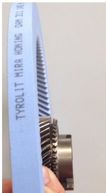
Obr. 0-10 Synchronizační ozubení přesahuje patní průměr ozubeného kola - možný jen malý úhel vyklonění (Schränkungswinkel) honovacího kroužku
