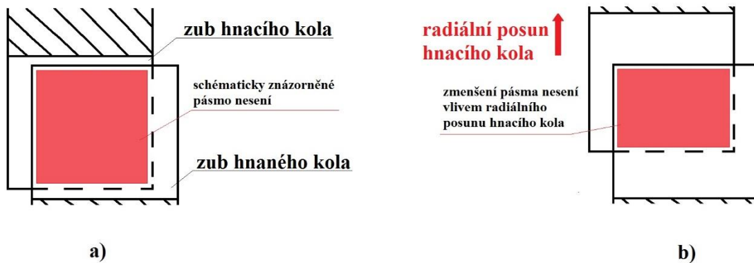
Obr. 2-10 Schématické znázornění pásma nesení a) bez radiálního posuvu kol b) s radiálním posunem kol
