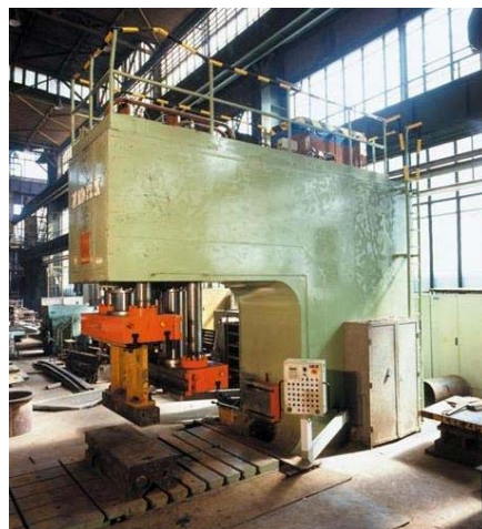
Obr. 3.2 Otevřený stojan univerzálního lisu CTC fy ŽĐAS [13]
