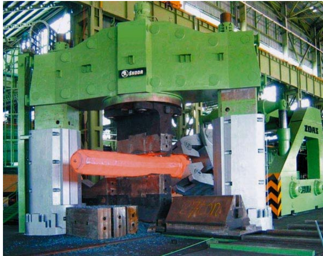
Obr. 4.4 Kovací soubor s lisem CKW 6300 a kolejovým manipulátorem QK 80 [13]
