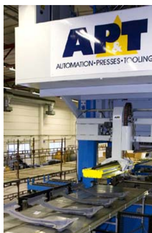
Obr. 5.3 Linka pro výrobu B sloupků technologií kalení lisováním [11]
