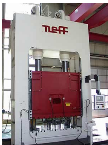
Obr. 5.5 Hlubokotažný lis DZP 400 s pulsačním přidržovačem [20]
