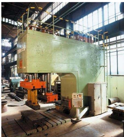
Obr. 3.2 Otevřený stojan univerzálního lisu CTC fy ŽĎAS [13]
