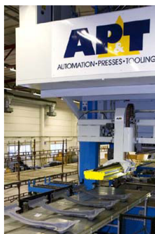
Obr. 5.3 Linka pro výrobu B sloupků technologií kalení lisováním [11]
