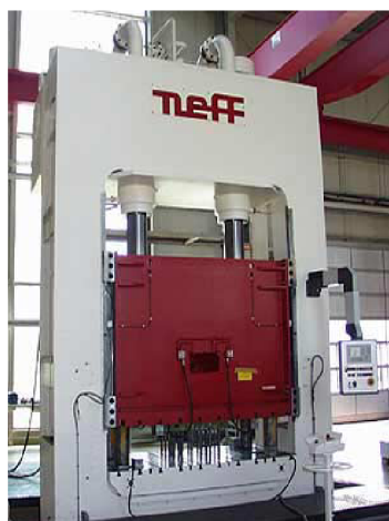
Obr. 5.5 Hlubokotažný lis DZP 400 s pulsačním přidržovačem [20]
