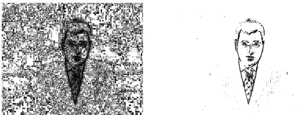
Obr. 3.4: Obraz diferenční matice a) se špatným nastavením prahu, b) a dobrým nastavením
