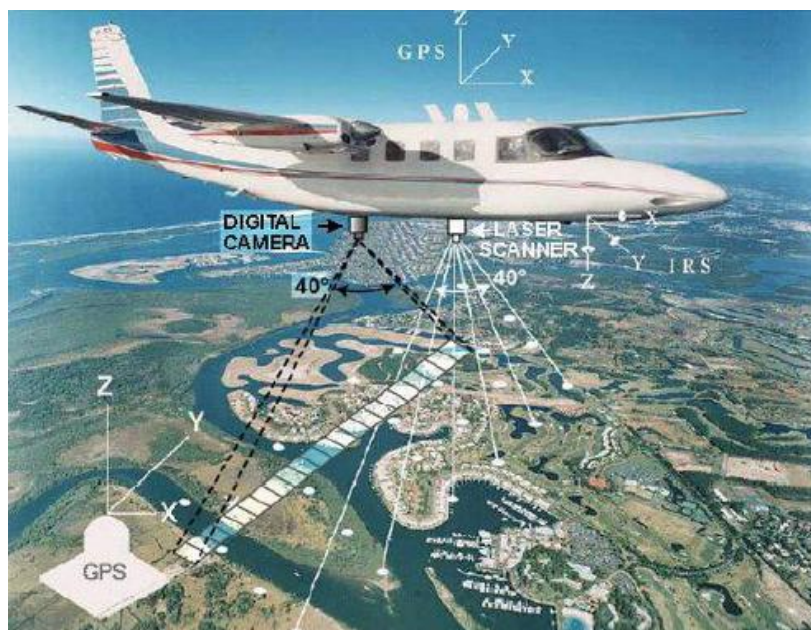
Obr. č. 2: Princíp leteckého laserového skenovania (Pavelka et al., 2011)
