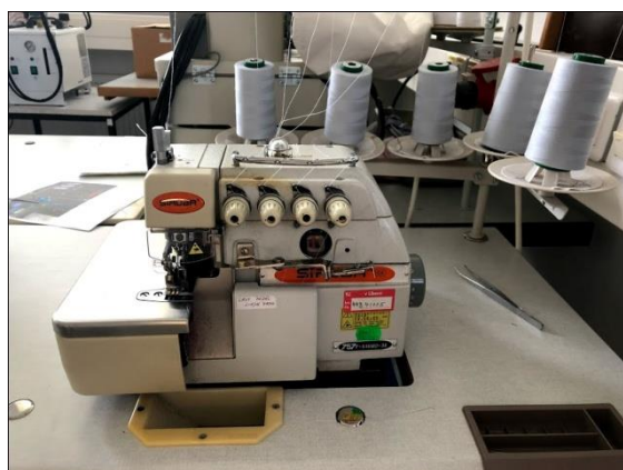
Obrázek 17: Dvoujehlový šicí stroj s 3nitným obnitkovacím stehem se stehem dvounitným řetízkovým
