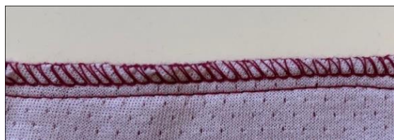
Obrázek 18: 3nitný obnitkovací steh se stehem dvounitným řetízkovým
