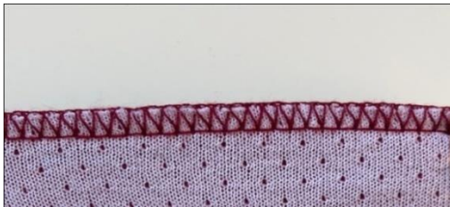
Obrázek 12: 3nitný obnitkovací steh
