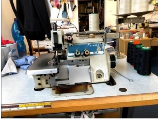
Obrázek 11: Jednoehlový šicí stroj s 3nitný obnitkovací stehem
