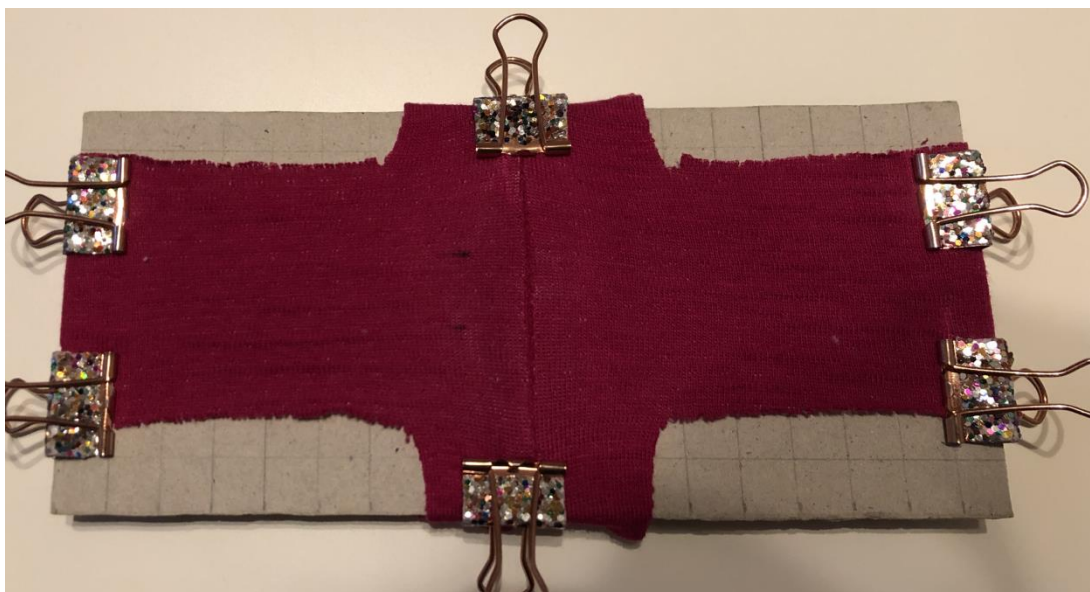
Obrázek 31: Upínací rámeček pro laboratorní testování s laboratorním vzorkem
