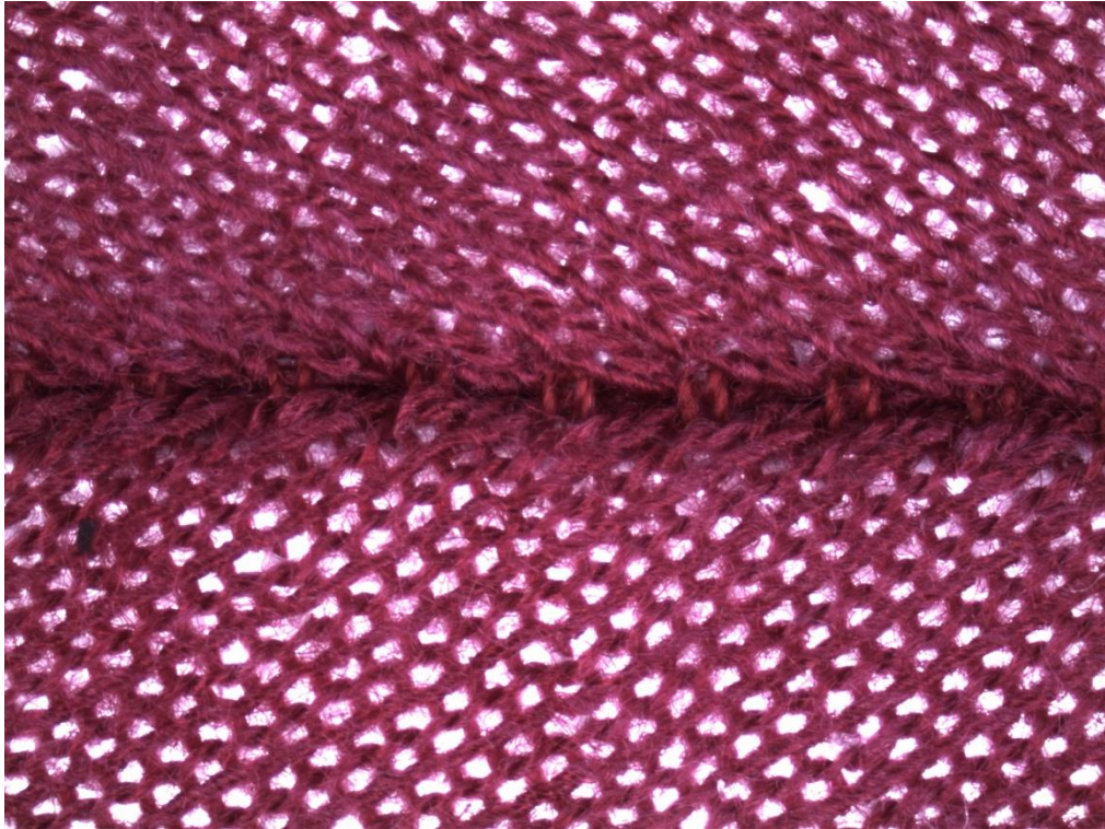
Obrázek 52: Šev č. 9 před zkouškou
