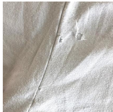
Obrázek 5b: Vada na zadním středovém švu
