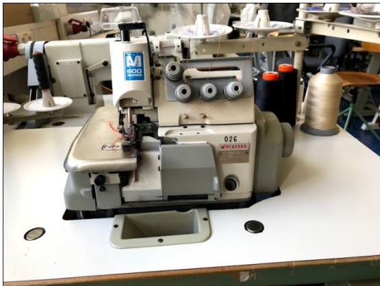
Obrázek 14: Dvouehlový šicí stroj s 4nitným obnitkovacím stehem se stehem zajišťovacím
