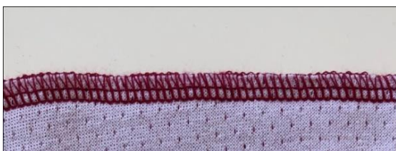
Obrázek 15: 4nitný obnitkovací steh se stehem zajišťovacím
