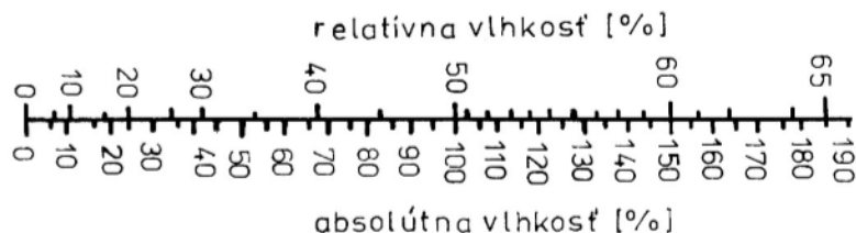
Obr. 2 Nomogram na přepočet absolutní a relativní vlhkosti dřeva (Požgaj et al., 1993)
