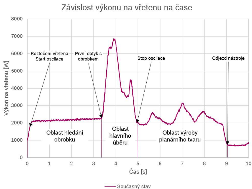
Obr. 53 Broušení čela, průběh výkonu na vřetenu.
