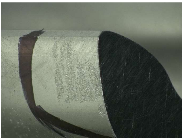
Obr. 40 Chybějící materiál, vada sintrování.
