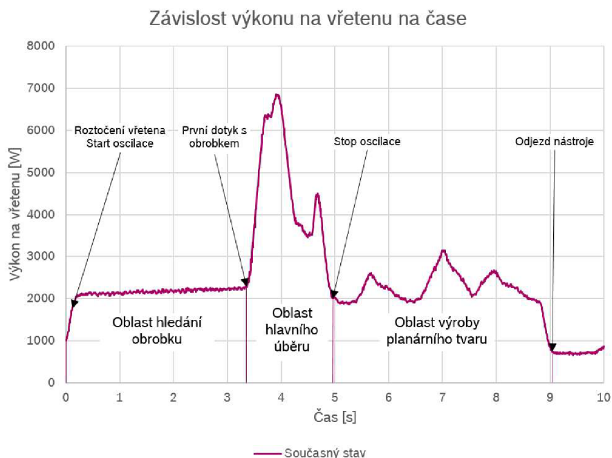
Obr. 53 Broušení čela, průběh výkonu na vřetenu.
