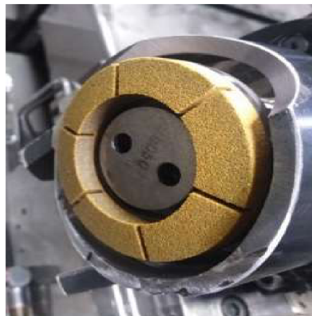
Obr. 46 Broušící kotouč s chladicími drážkami.
