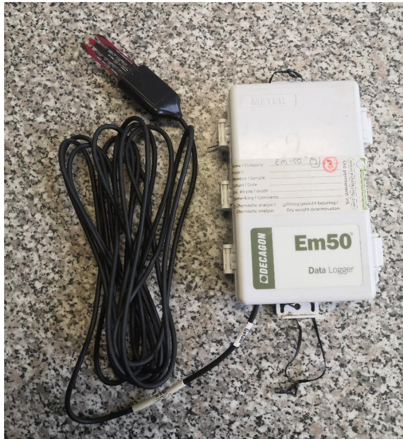
Obrázek 16: Senzor půdní vlhkosti 5TE
