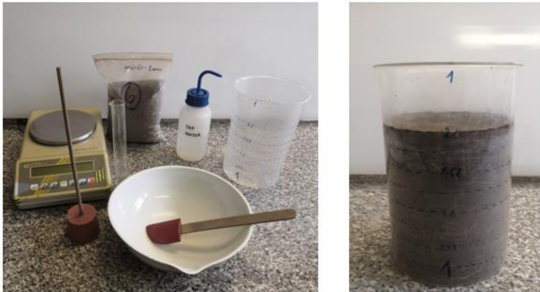
Obrázek 13: Příprava vzorku a nahutněný vzorek před infiltračním experimentem
