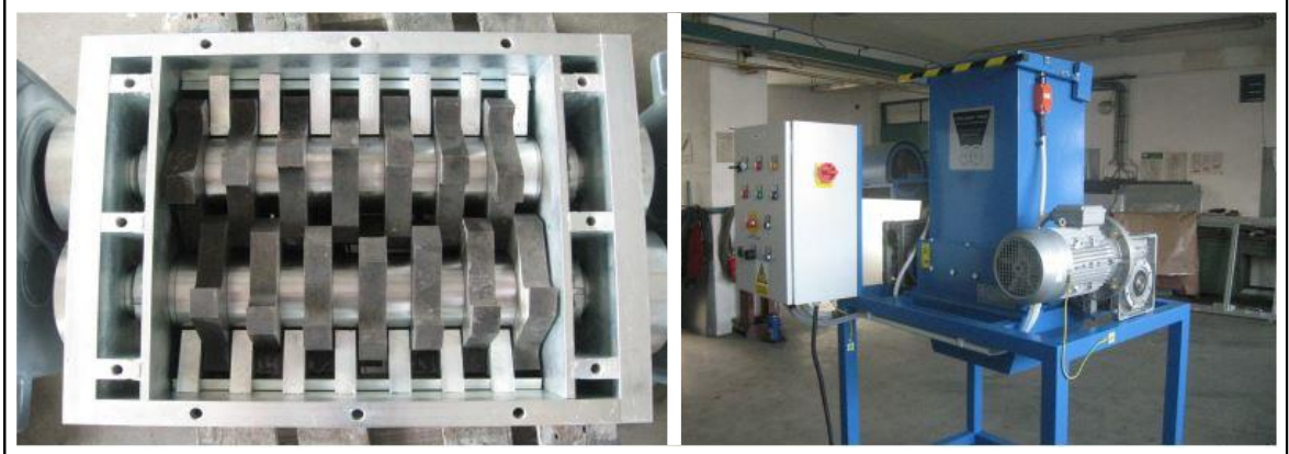
Obrázek 10: dvouhřídelový hrubý drtič. (jelínek-stroje.cz, 2022)
