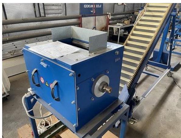
Obrázek 22: magnetická separace. (autor, 2022)
