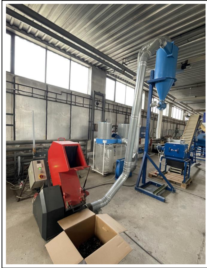
Obrázek 12: pneumatický dopravník s cyklonovým odlučovačem. (autor, 2022)
