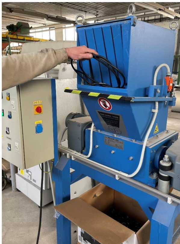
Obrázek 19: podávání kusových kabelů do hrubého drtiče. (autor, 2022)
