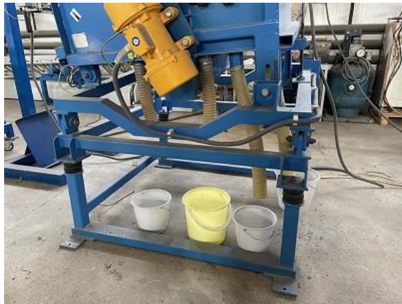
Obrázek 23: separace fluidním splavem. (autor, 2022)
