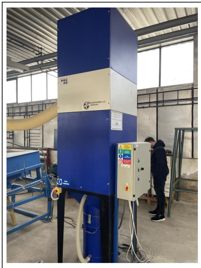
Obrázek 17: podtlaková odsavač POC – 20 JET. (autor, 2022)
