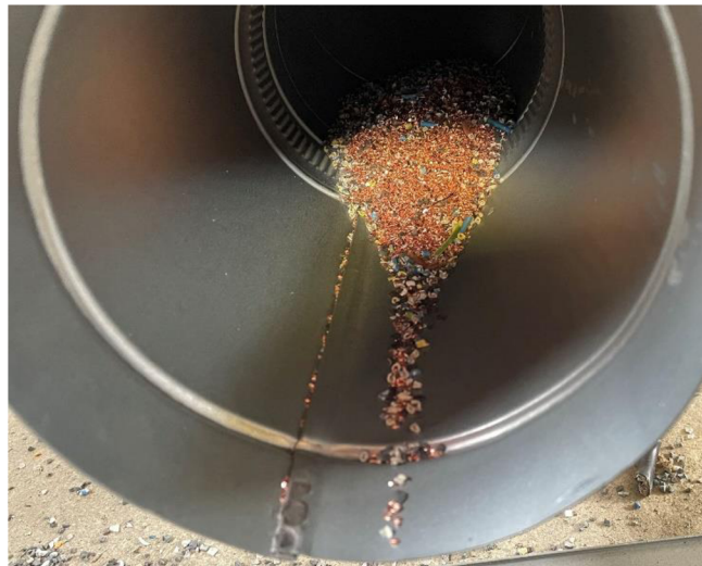
Obrázek 20: detail trubky pneumatického dopravníku. (autor, 2022)
