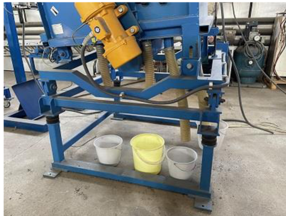
Obrázek 23: separace fluidním splavem. (autor, 2022)
