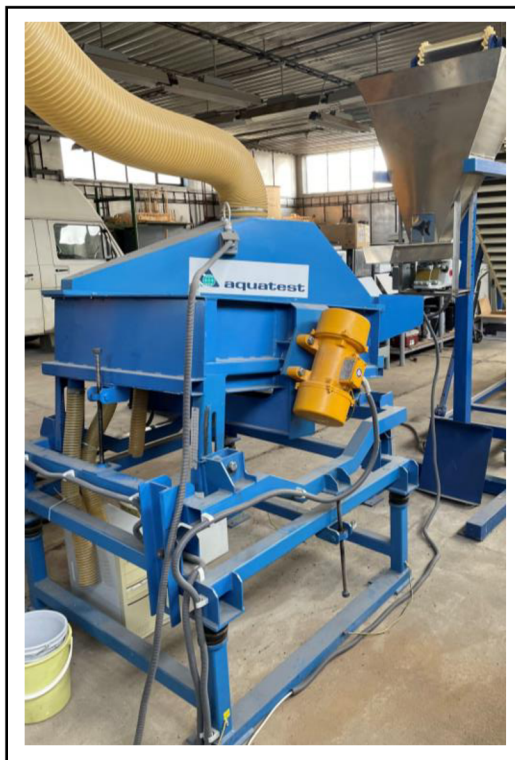
Obrázek 16: fluidní splav FS-1. (autor, 2022)
