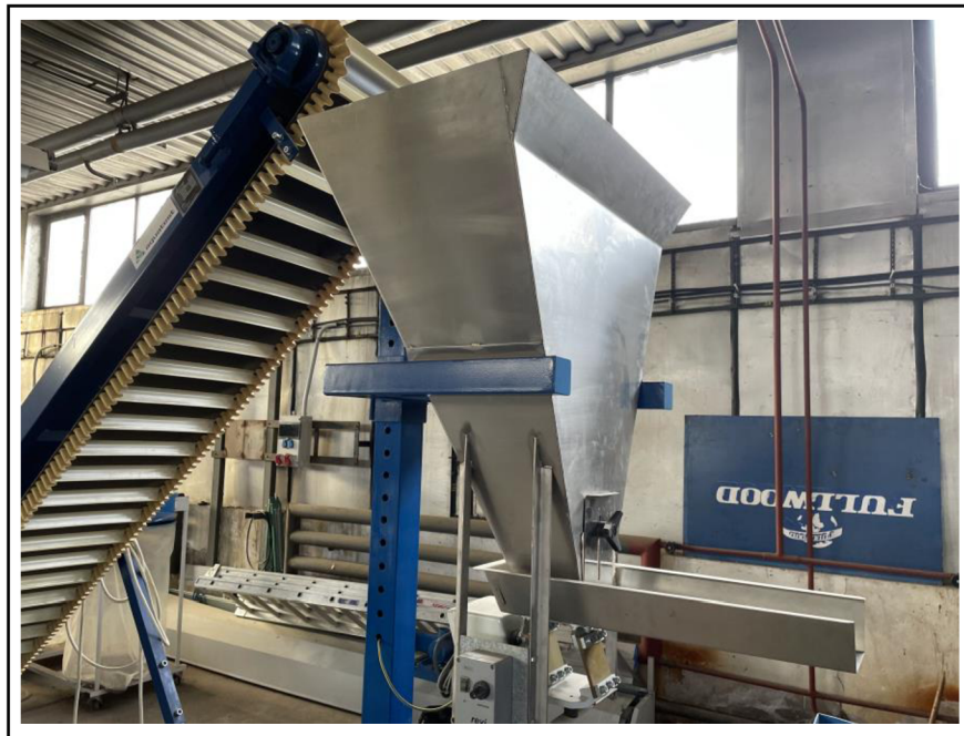
Obrázek 14: pásový dopravník ODES DPK 400/3,5. (autor, 2022)
