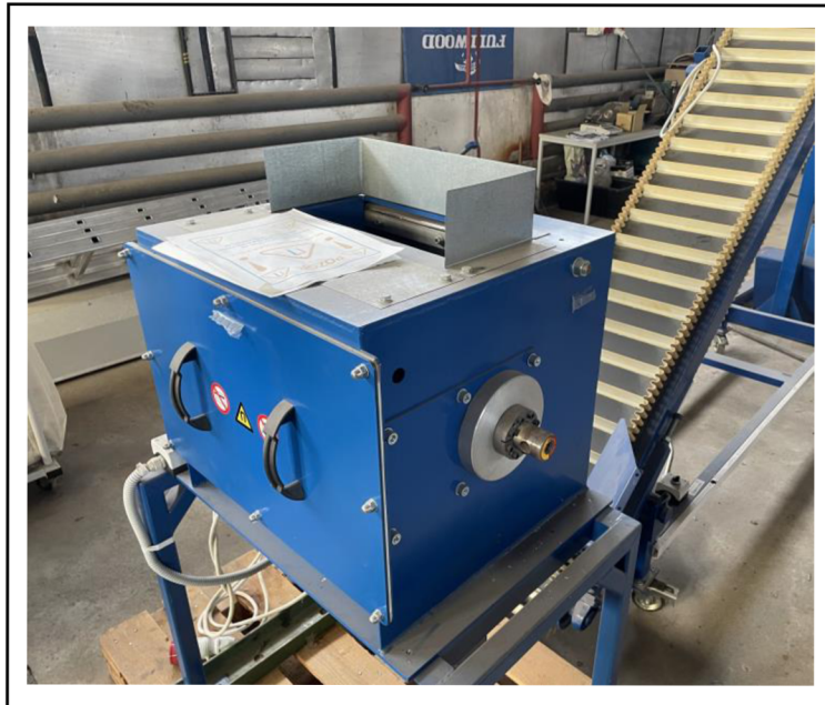
Obrázek 13: magnetický separátor Wamag SRTK040034. (autor, 2022)
