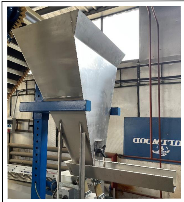
Obrázek 15: vibrační podavač ROX MX 200. (autor, 2022)
