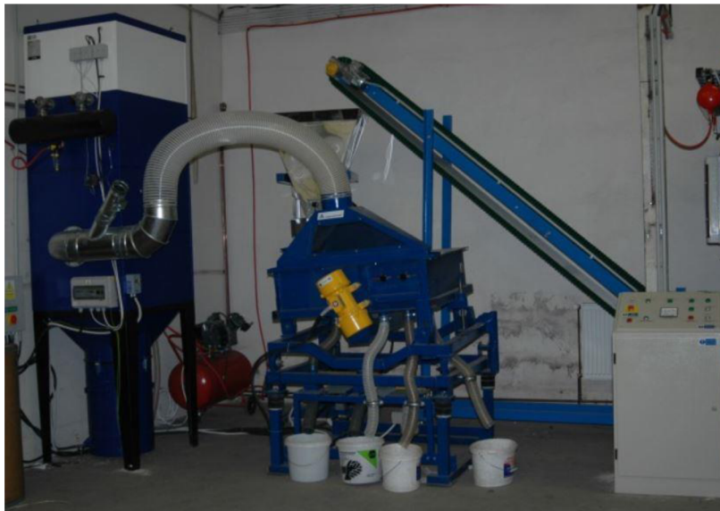
Obrázek 5: fluidní splav. (Jelínek-Stroje, 2022)
