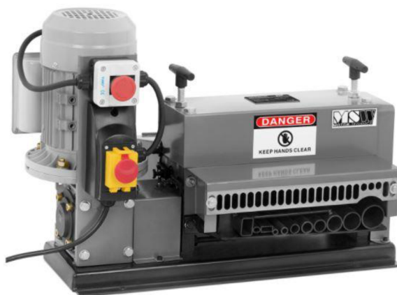
Obrázek 4: elektrická svlíkačka Bronnenberg. (Bronnenberg, 2012)
