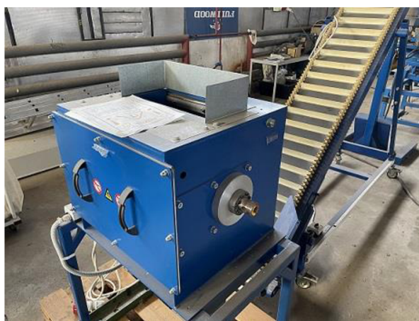
Obrázek 22: magnetická separace. (autor, 2022)
