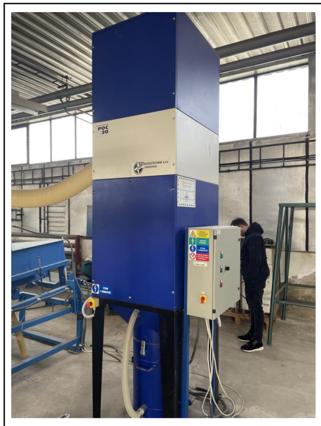
Obrázek 17: podtlaková odsavač POC – 20 JET. (autor, 2022)
