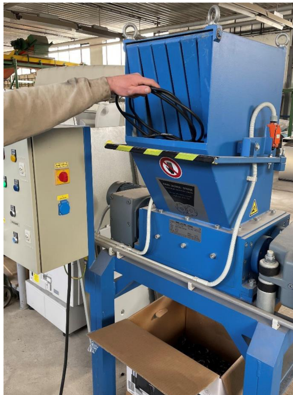
Obrázek 19: podávání kusových kabelů do hrubého drtiče. (autor, 2022)
