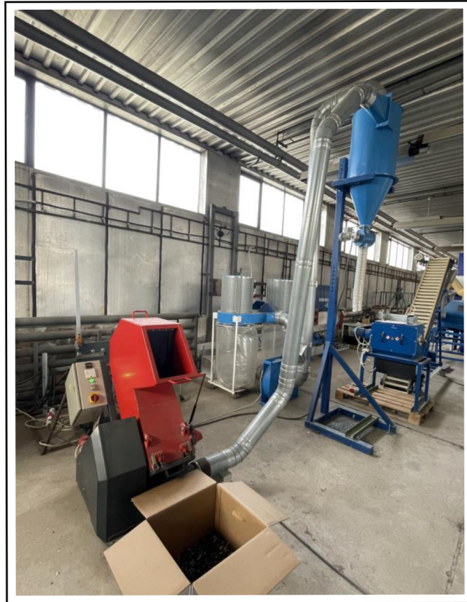
Obrázek 12: pneumatický dopravník s cyklonovým odlučovačem. (autor, 2022)
