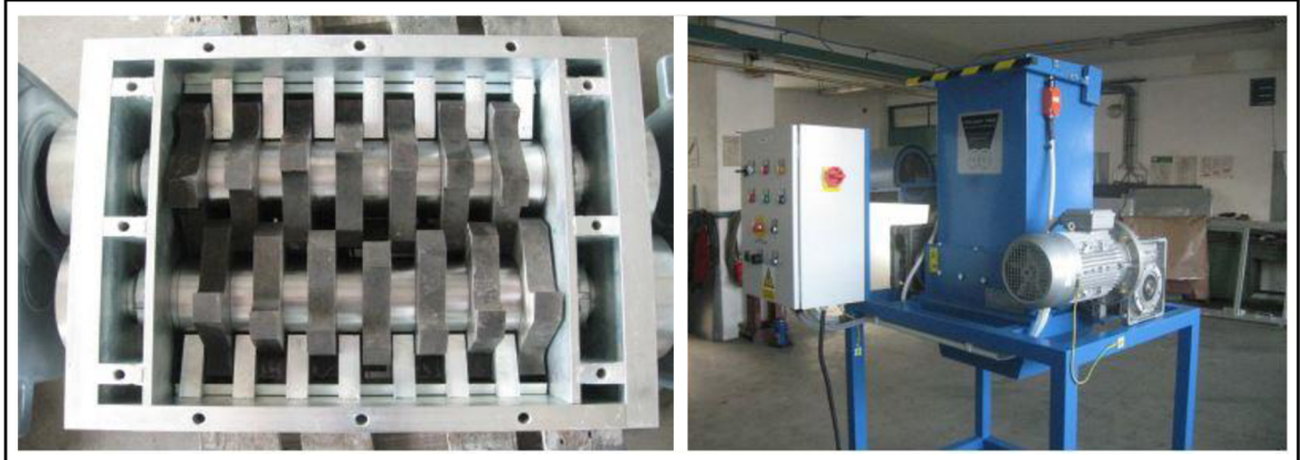
Obrázek 10: dvouhřídelový hrubý drtič. (jelínek-stroje.cz, 2022)
