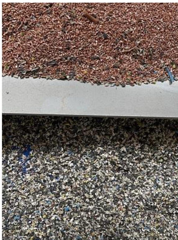
Obrázek 21: detail výstupní frakce z nožového mlýna. (autor, 2022)
