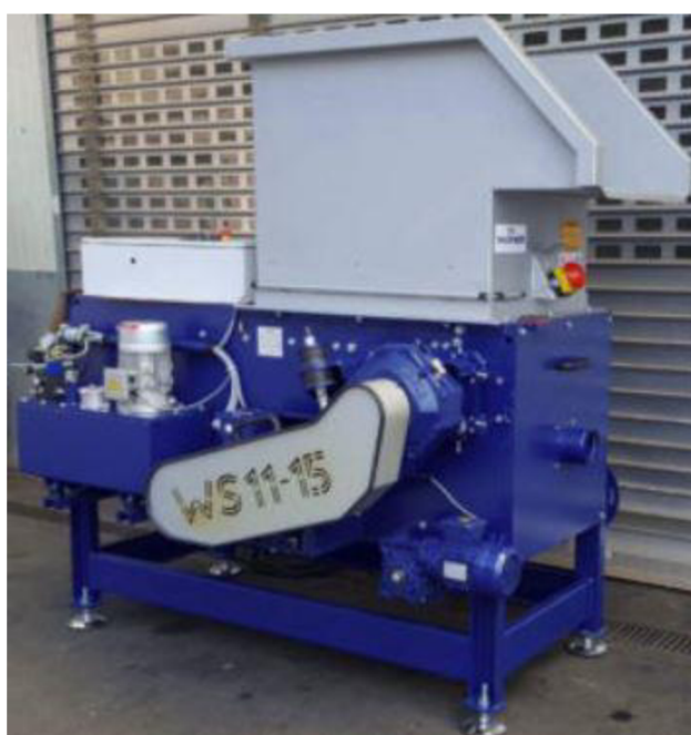
Obrázek 3: drtič kabelů Wagner-Simenia.(Simenia.com, 2022)
