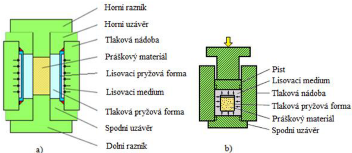
Obr. 2.2 Principiální schéma izostatického lisování za studena:
