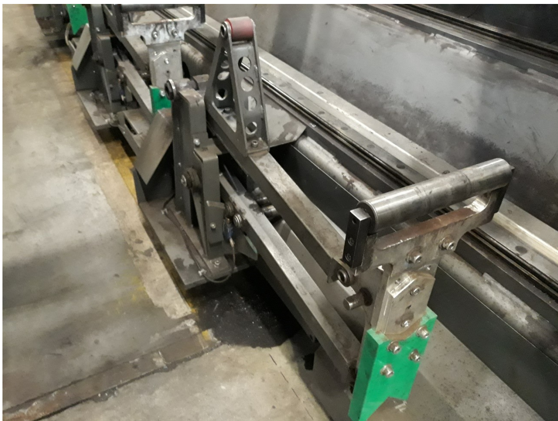
Obr. 5.7. BLM LT8 - řešení podpěr na těžších strojích
