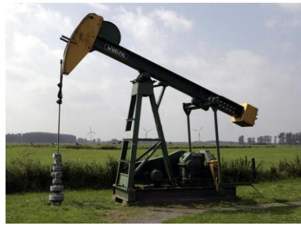
Obr. 3 Pumpa pro získávání ropy z nalezišť s nízkým tlakem [5]
