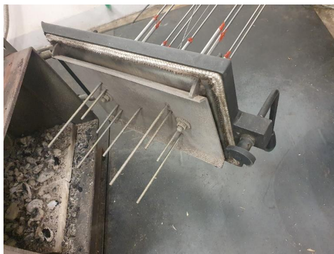
Obr. 19 Fotografia TE článkov v oblasti dvierok kotla
