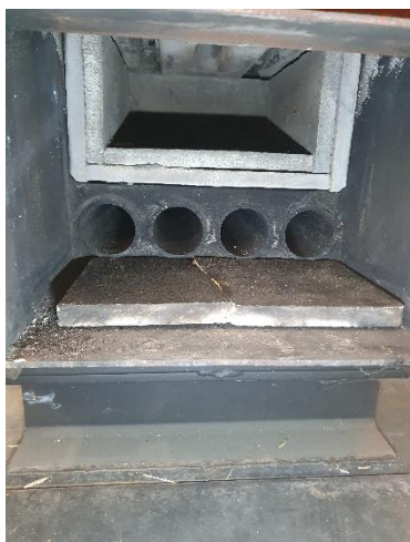
Obr. 29 Šamotové obloženie spaľovacej komory
