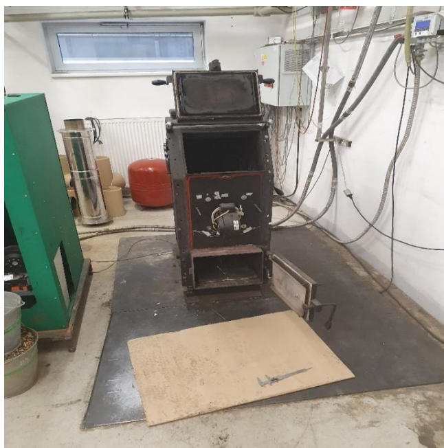
Obr. 12 Prototyp splyňovacieho kotla Ekoscroll o výkone 25 kW th
