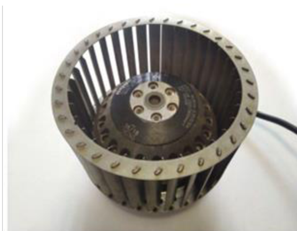
Obr. 17 Pohľad na demontované obežné koleso
