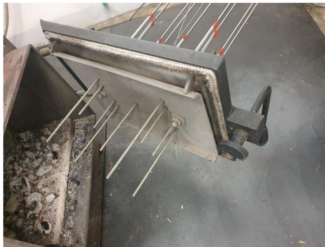
Obr. 19 Fotografia TE článkov v oblasti dvierok kotla
