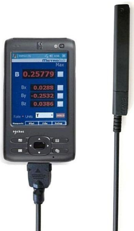
Obr. 1.11 Hallova sonda se třemi články
