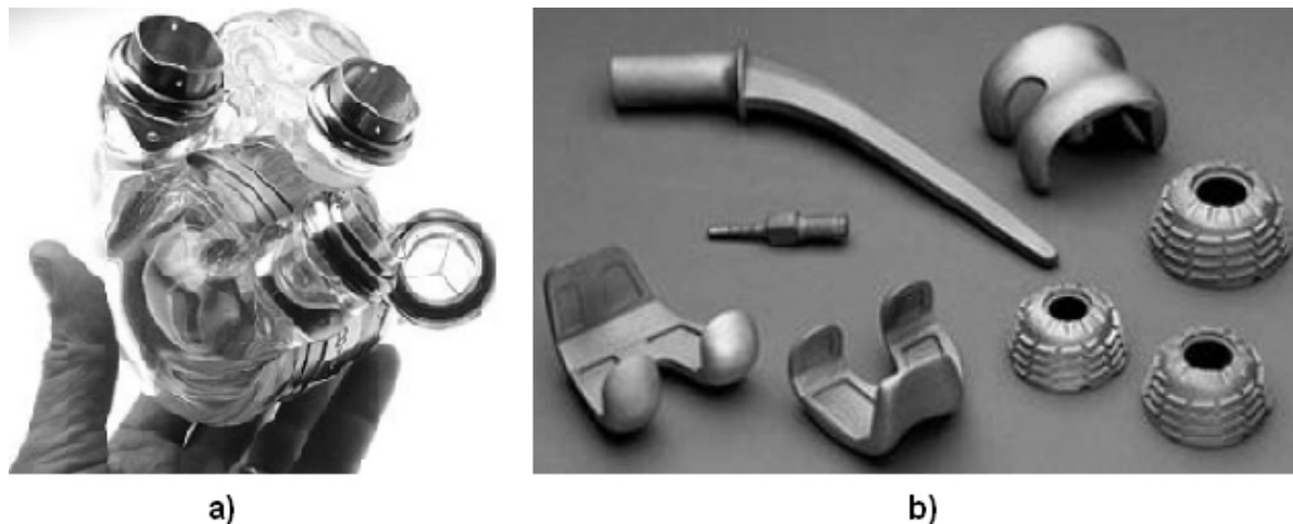
Obr. 1.29: a) Titanové části umělého srdce b) Lité kloubní náhrady [8]
