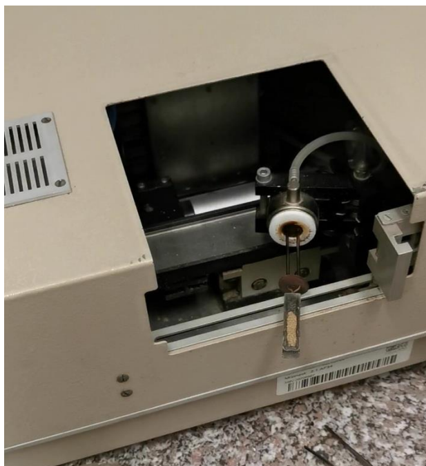
Obrázek 4: Navážený lyofilizovaný vzorek v navažovací loďce ve spektrometru před změřením (foto: vlastní)
