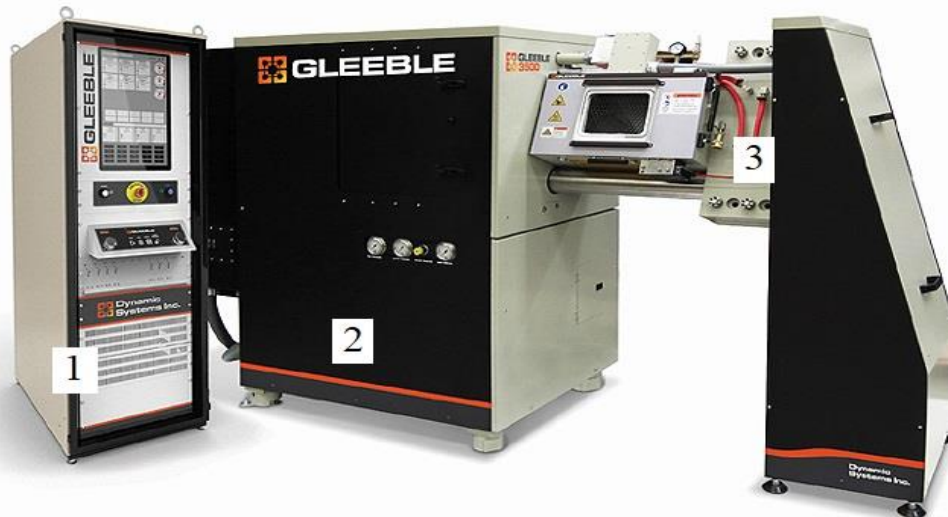
Obr. 2.6.1 Zařízení Gleeble 3500 1-ovládací panel, 2-hlavní jednotka, 3-testovací zařízení [14]
