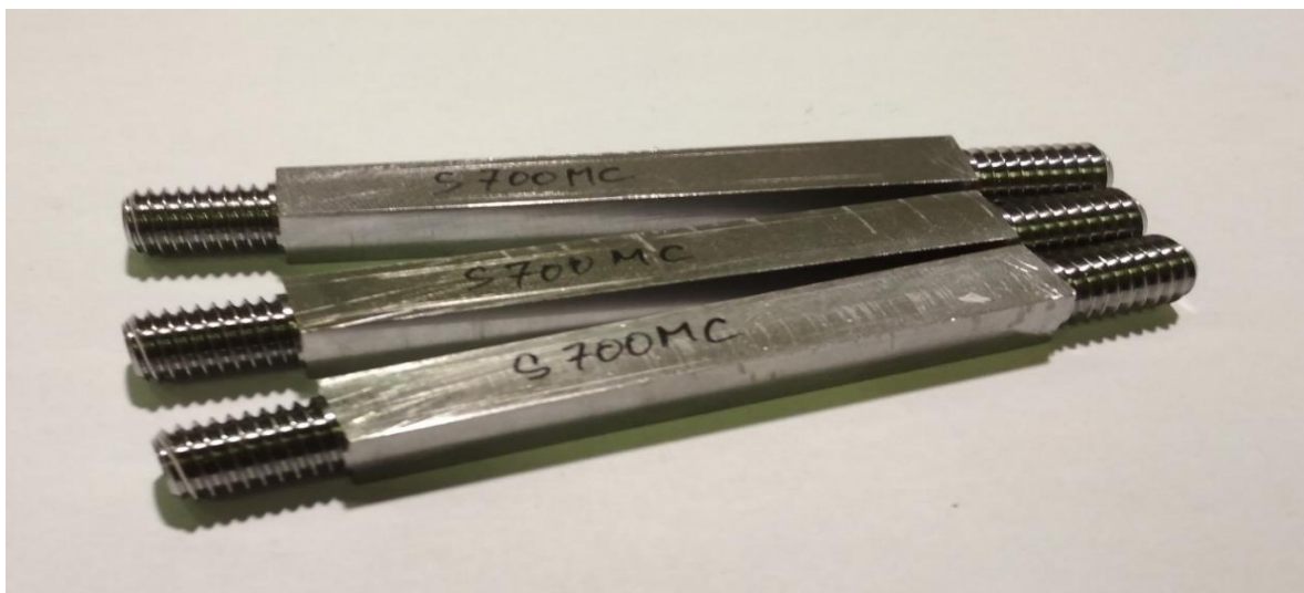
Obr. 3.1.2 Hotové vzorky pro simulaci teplotních cyklů
