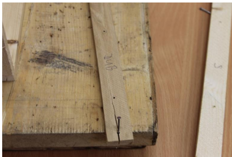
Obrázek 27 Zatloukání hřebíku do přířezu z dubového dřeva
