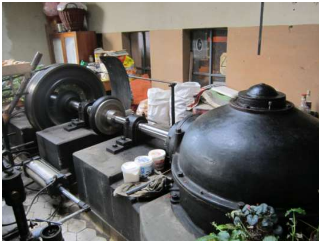
Příloha č. 15 Mlýn č. p. 27, Tržek. Stále funkční turbína.
