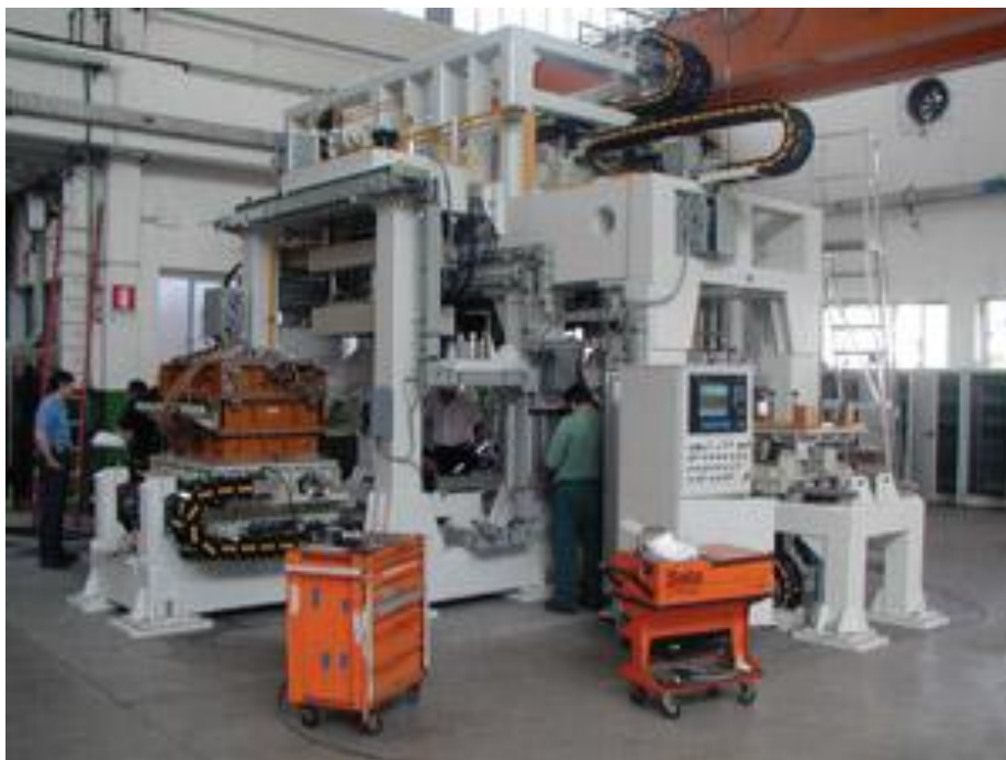
Obr. 6 Stroj na výrobu jader navržený pro pojivo GMBOND [18]
