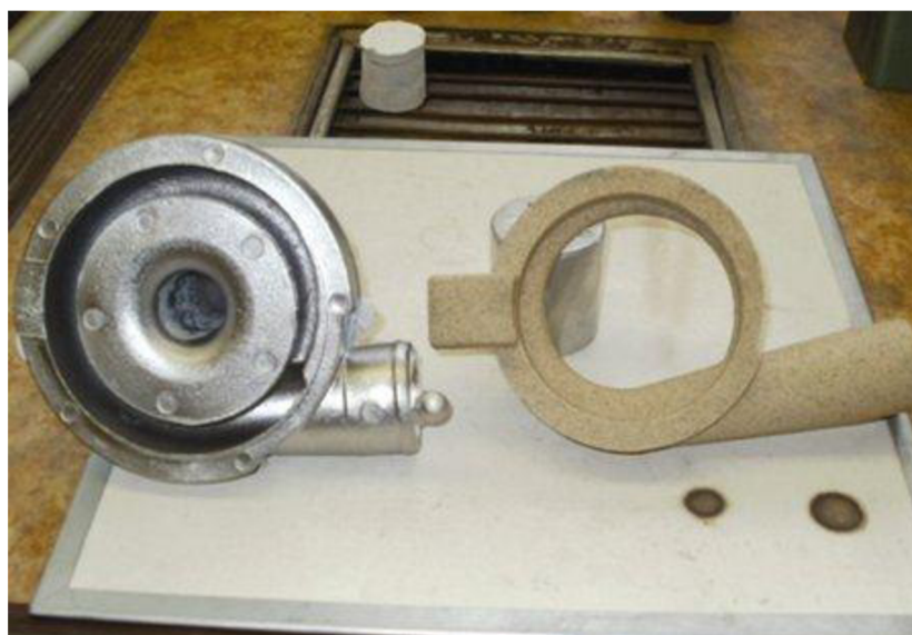
Obr. 16 Odlitek z Al slitiny a jádro – slévárna Metaz Týnec nad Sázavou [30]
