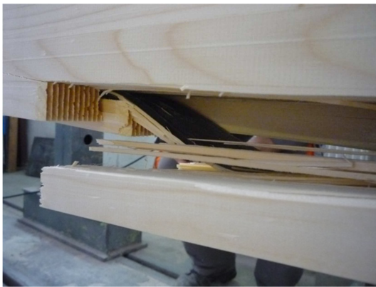
Obr. 8.1 – Porušený nosník s CFRP lamelou
