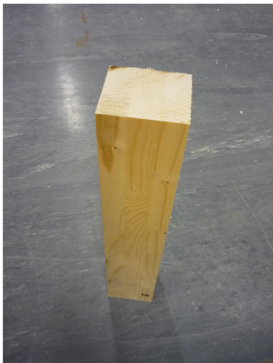
Foto 19 – Zkušební těleso pro zkoušku pevnosti v tlaku
