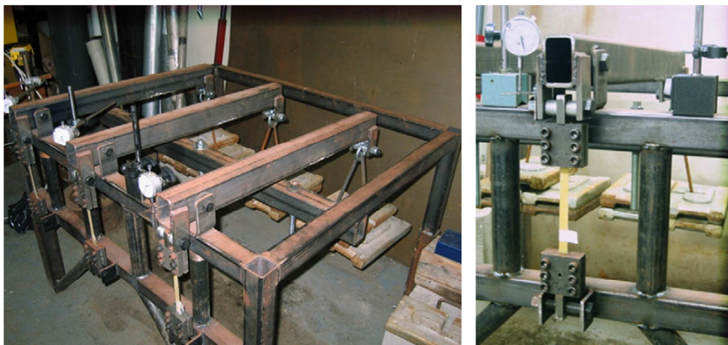
Obr. 3.9 – Tahová zkouška tečení AFRP výztuží
