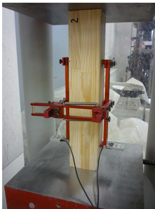
Foto 22 – Osazené snímače deformací pro zkoušku modulu pružnosti v tlaku
