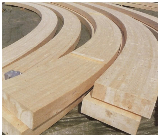
Obr. 4.4 – Obloukové nosníky z LLD [14]
