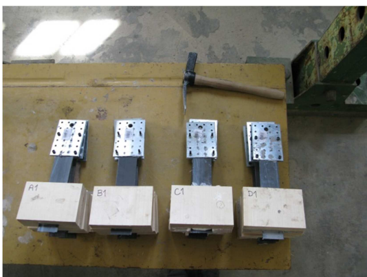
Foto 27 – Zkušební tělesa pro Pull-out zkoušky pevností lepeného spoje
