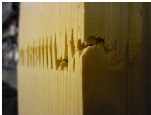
Foto 16 – Porušení trámku v lepeném zubovitém spoji
