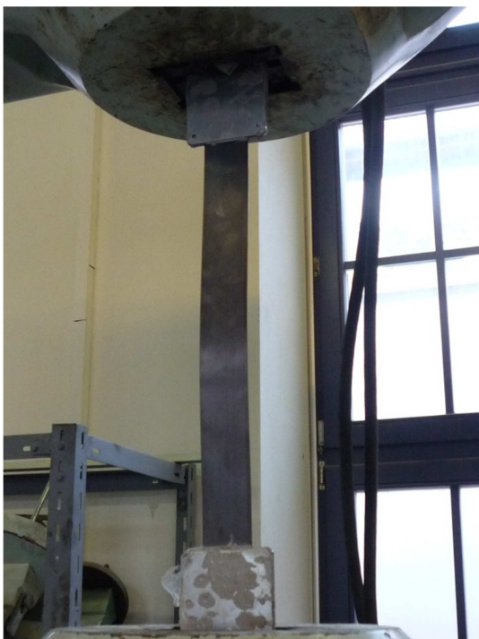
Foto 23 – Zkušební těleso pro zkoušku pevnosti CFRP lamely v tahu
