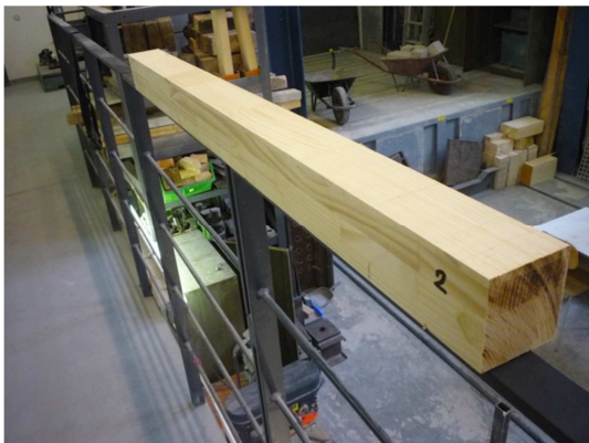
Foto 13 – Zkušební těleso pro stanovení pevnosti v ohybu
