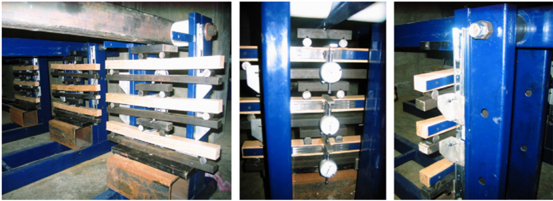
Obr. 3.11 – Dlouhodobá zatěžovací zkouška čtyřbodovým ohybem
