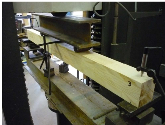
Foto 14 – Zatěžovací zkouška pevnosti v ohybu
