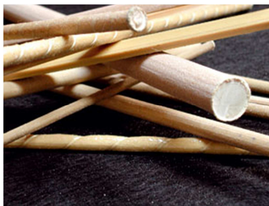
Obr. 4.9 – Výztuž z aramidových vláken [9]
