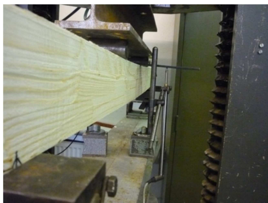
Obr. 4.17 – Průhyb zkoušeného trámku
