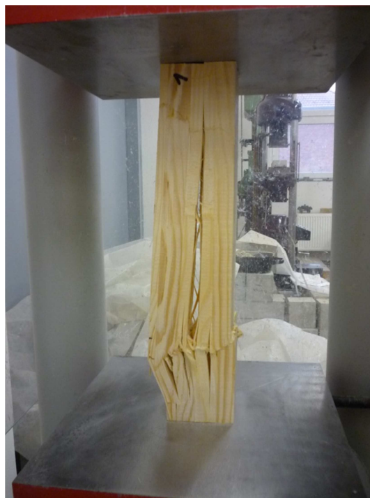
Foto 20 – Zkušební těleso po zkoušce pevnosti v tlaku
