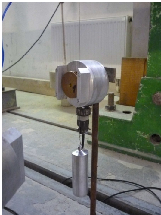
Foto 7 – Měřič průhybu nosníku
