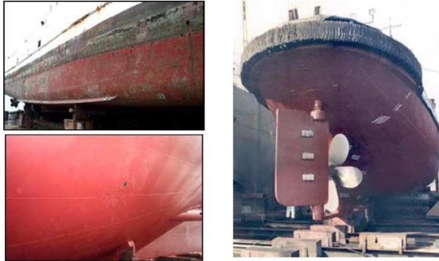
Obr.10 Umístění obětovaných anod na plášti a kormidle lodi; zdroj: přednášky, Černý 2014
