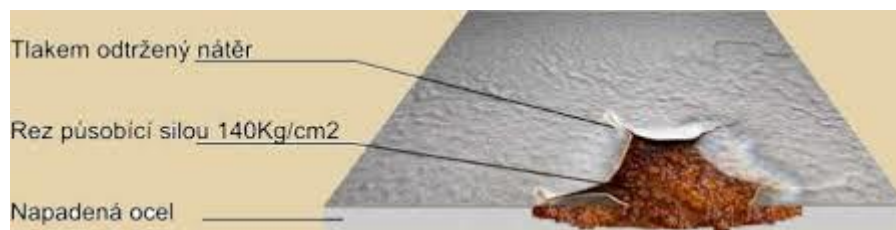
Obr.1 Koroze pod nátěrem; zdroj: www.reprof.eu
