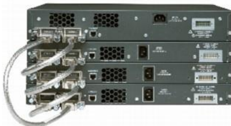
Obrázek 2.2: Propojení přepínačů speciálním kabelem do stohu [9]
