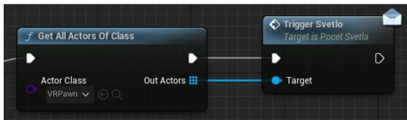
Obrázek 13 - Unreal Engine systém nodů pro zaslání informace o zapnutí světel (Zdroj: autor)
