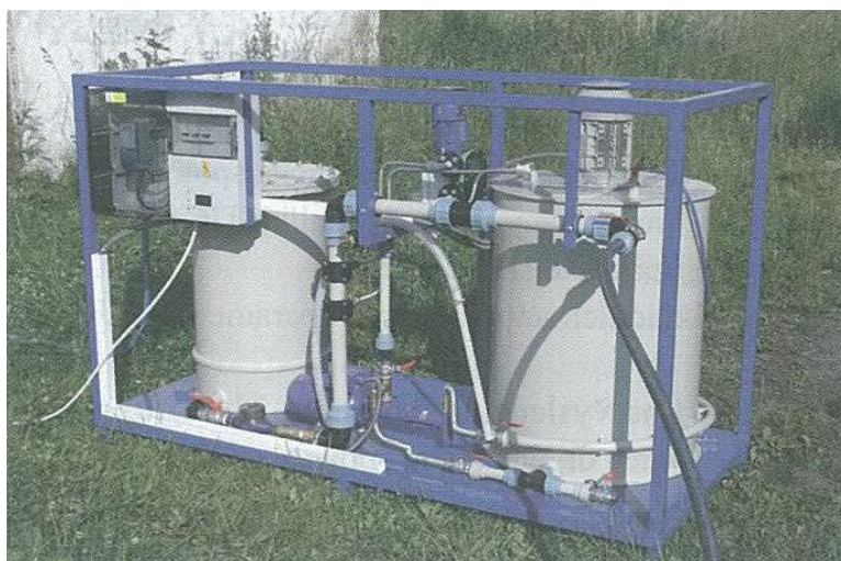
Obrázek 9: Aplikační zařízení pro injektáž nZVI [28]
