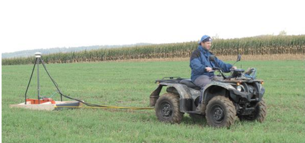
Obr. 11: Měřicí souprava pro měření vodivosti půdy pomocí elektromagnetického senzoru EM 38 (foto Kroulík, 2013)
