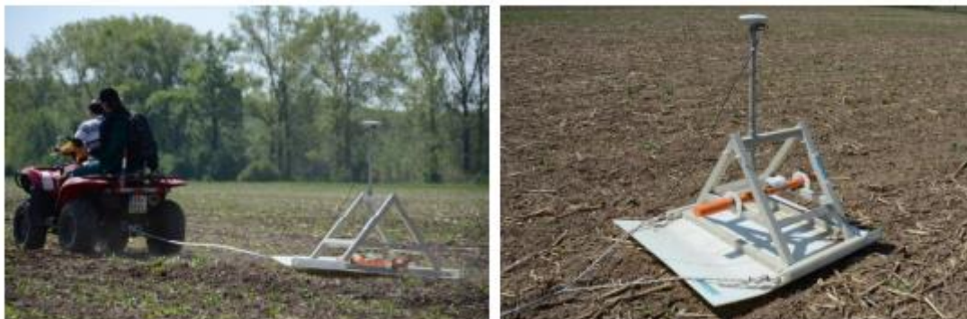
Obr. 3: Měření el. vodivosti při jízdě (vlevo), vpravo detail měřícího zařízení (Lukas et al., 2011)
