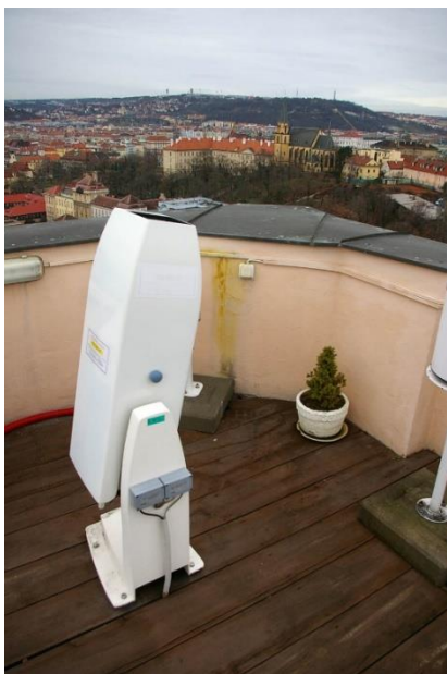
Obr. 7 Laserový ceilometr CT25K na stanici Praha – Karlov
