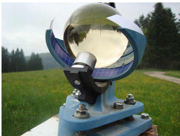
Obr. 2 Campbellův a Stokesův heliograf
